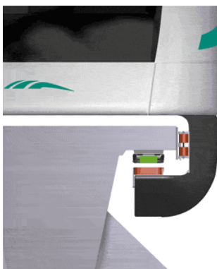
Slika br.13.8.55. Sistem namotaja koji omogućava magnetno lebdjenje vozila
